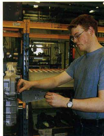
Det här fästet som Christer Strömgren arbetar med är typexempel på en artikel som kan sättas fast på ett ställe, i stället för att montören först ska fästa, sedan backa och sedan fästa skruvarna igen.
